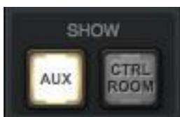
*El switch de mostrar auxiliares en la columna de monitor*
