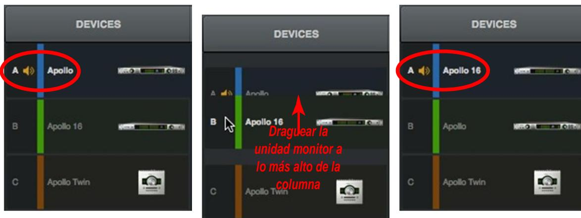
Designando la unidad de monitor en el panel de hardware dentro de los ajustes de la Consola
