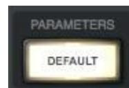
**Nota:** La función por defecto es primariamente para los valores de las perillas y los faders. No se aplica a cualquier ajuste de pre-amplificador, inserciones de plug-in, SOLO / switches MUTE, niveles de monitorización, los nombres de entrada personalizados, y funciones similares.
