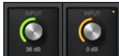
Si el plug-in Unison está inactivo (por medio del switch de habilitación/deshabilitación del inserto o por el switch de potencia de la interfaz del plug-in), el color vuelve a ser verde.
