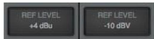
Los ajustes controlan un pad de atenuación para la entrada de un canal. Cuando se fija a +4 dBu y el pad es activado, el canal puede aceptar una señal más alta antes de que el conversor A/D comience a clipear. Cuando se selecciona -10 dBV se deberán usar señales de entrada más bajas.
