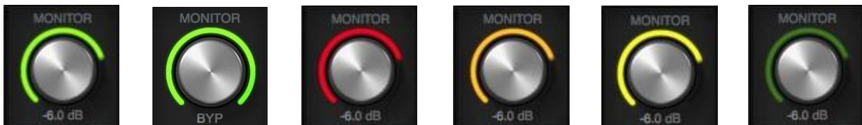
Indicador de nivel de los monitores (de izquierda a derecha): Normal, Bypass, Mute, ALT 1, ALT 2, y DIMMONO
