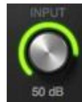
Girando la perilla en el sentido de las agujas del reloj se incrementa la ganancia del canal. El rango de ganancia disponible para los canales que tienen pre-amplificador (1-4) va de 10 dB a 65 dB para entrada de Mic, línea o HI-Z.
